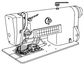
Einrichtung zum Beschneiden der oberen Stofflage
